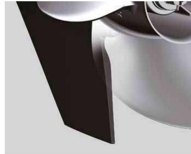
El perfil del ataque de la cola, la localización y diseño de los filtros de agua se han cambiado para mejorar el rendimiento de crucero y la resistencia contra la cavitación.
