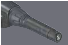
Pulsador Power Trim & Tilt y ajuste de la resistencia del acelerador.
